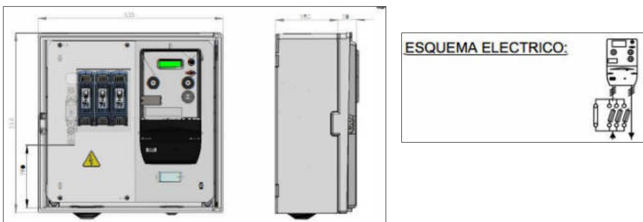
Imagen E4.11.2.1. Armario de medida y esquema eléctrico
