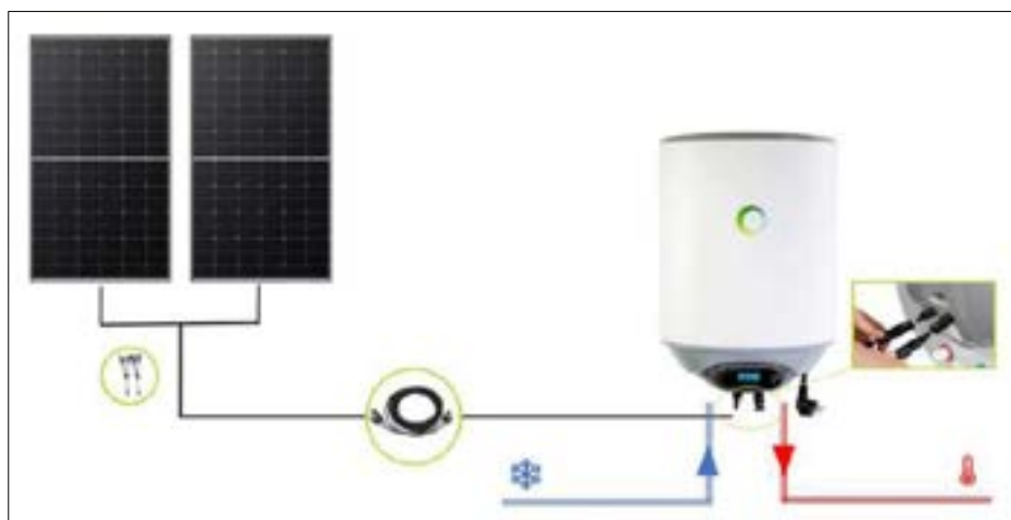
Imagen E7.8.3.1. Esquema conexión eléctrica e hidráulica.
