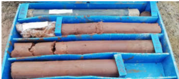
Foto 6.3.1 Aspecto de esta unidad en el sondeo 1
